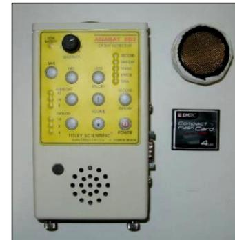
Le matériel utilisé est du type **Anabat SD2** : C'est un appareil complet qui intègre un détecteur à ultrasons fonctionnant sur le principe de la division de fréquence et un module permettant d'enregistrer directement les signaux captés sur une carte mémoire de grande capacité. A l'issue de la séance d'enregistrement les données stockées sont transférées sur PC grâce au logiciel CFRead et visualisées (pour détermination) avec le logiciel Analook.
